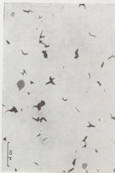
Fig. 37. — Fonte à graphite diffus de recuit sans attaque; graphite lamellaire monocristallin.
