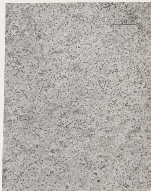
Fig. 36. — Fonte à graphite diffus de recuit; matrice perlitique.
