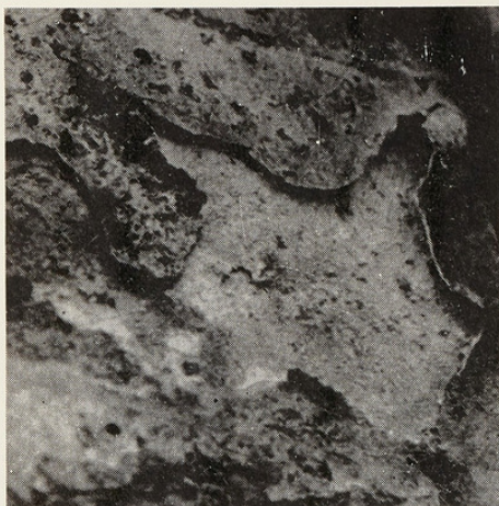
13. ANGOULÊME (Charente). — Calcaire crayeux. — Crétacé sup r . — Lésion en plaque plus évoluée (Cl. M.H. 155-138).
