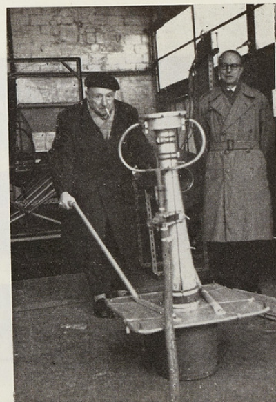
FIG. 10. — Dispositif d'essai de jupes (alimentation par trompe).
