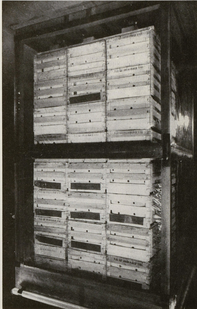
CLICHÉ 2. — Caissons à paroi d'éthylcellulose pour la conservation en atmosphère contrôlée de pommes ou de poires. Les fruits sont stockés dans des caisses à l'intérieur.
