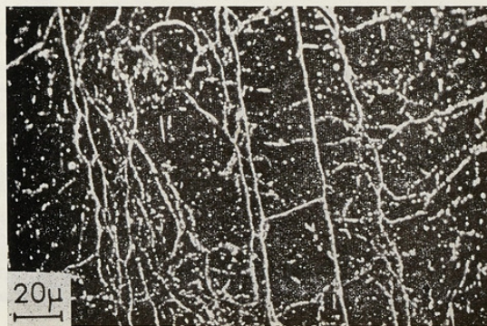
FIG. 7. — Monocristal de cuivre 99,999 % allongé de 5 % et recuit 40 heures à 1 040 °C. Les sous-joints sont révélés par attaque acéto-nitrique après sulfuration superficielle et recuit de diffusion de 100 heures à 500 °C.
