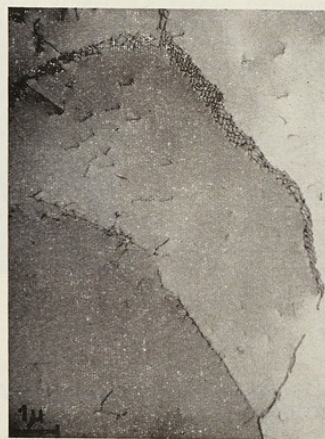
d) 600 °C : sous-grain de polygonisation bien individualisé
