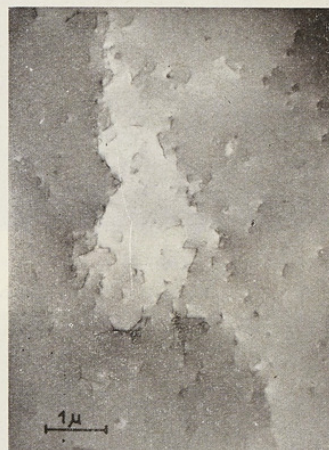
b) 550 °C : alignements en cours de formation à partir des dislocations dispersées
