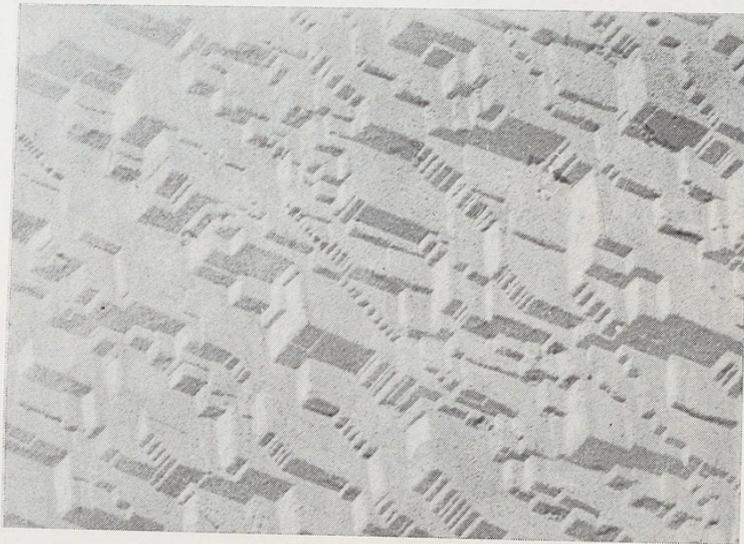
FIG. 18. — Striation de la surface des joints de grains, due à la chimisorption du carbone. Microfractographie électronique.  $G \times 20.000$ .
