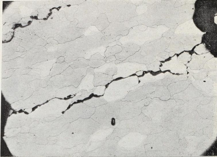
FIG. 4. — Propagation d'une fissure dans un échantillon de molybdène polycristallin. G  $\times$  800.
