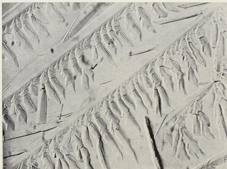
FIG. 15. — Précipitation du carbure de molybdène à la surface du métal après refroidissement lent. G  $\times$  600.
