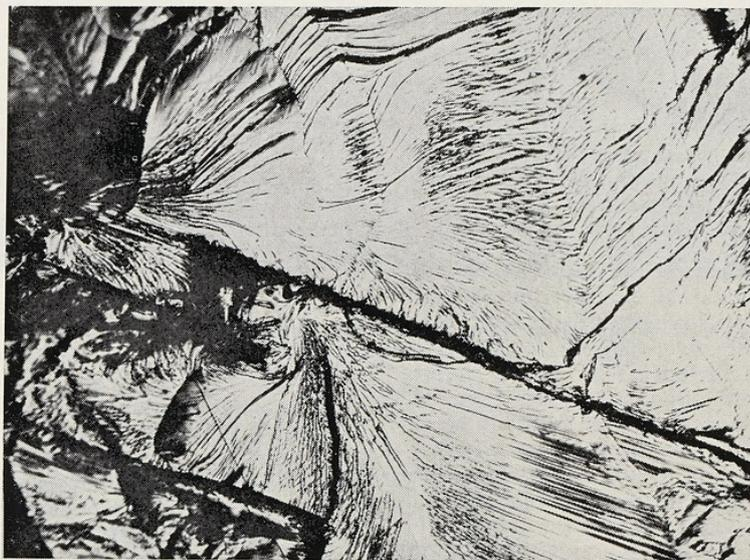
FIG. 3. — Microfractographie du tungstène : plan de clivage. G.  $\times$  120.
