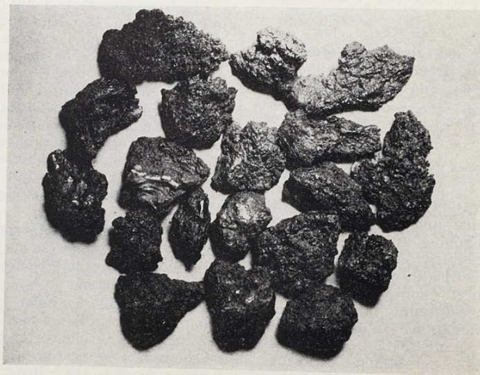
FIG. 2. — Eponge de titane obtenu par le procédé Kroll (diamètre des granulés de l'ordre du cm).
