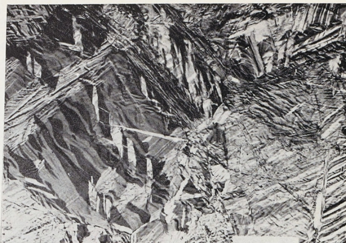
Fig. 9. — Titane déformé par laminage à température ambiante (réduction de section de 26 %) repère de 100 \mu (lumière polarisée).
