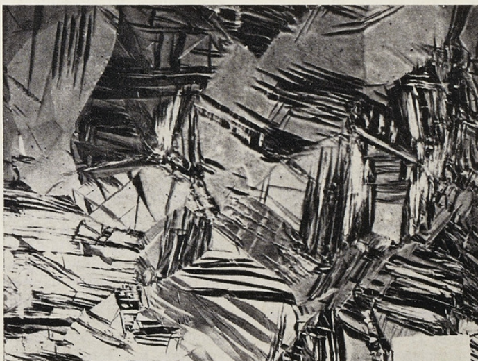
FIG. 8. — Titane déformé de 35 % par traction à température ambiante (repère de 100 \mu ) (lumière polarisée).
