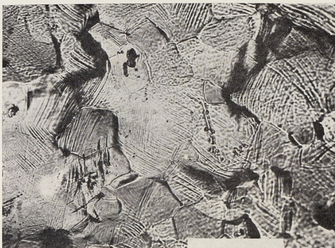
FIG. 7. — Zirconium déformé de 20 % par traction à température ambiante (repère de 100 \mu ).
