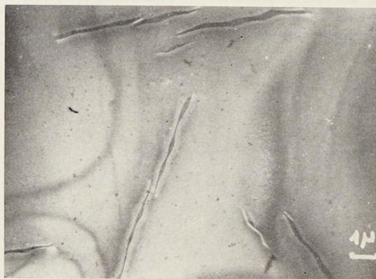
FIG. 15. — \times 7.000 . Fer nitruré trempé revenu jusqu'à 250°. La morphologie de la précipitation change
