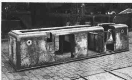
Bâti de dénudeuse-brrosseuse construit par soudage
