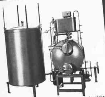
Générateur d'acétylène Safotec à chaux résiduaire sèche
