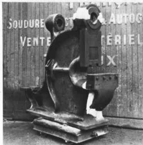
Arbre-vilebrequin réparé par soudage
