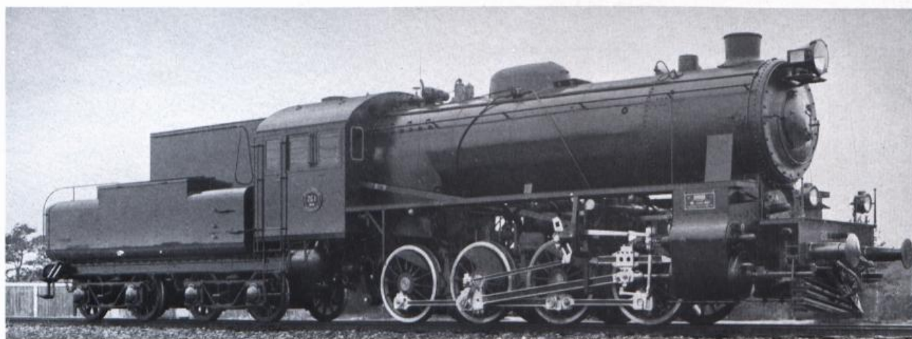
CHEMINS DE FER NEERLANDAIS. La locomotive, construite par NOHAB, Suède, est entièrement équipée de boîtes à rouleaux. Poids en service de la locomotive 74 tonnes, du tender 23,5 tonnes.
