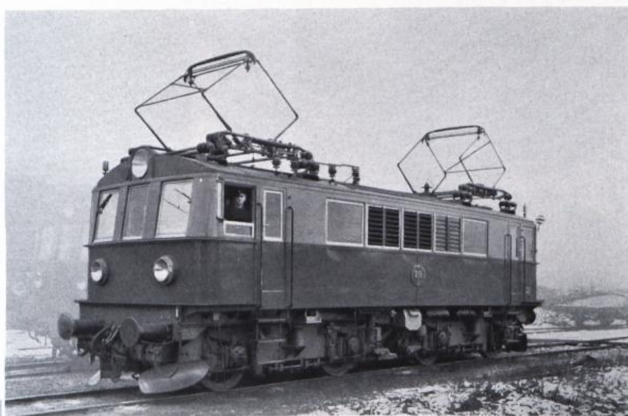
CHEMINS DE FER DE L'ÉTAT SUÉDOIS. Locomotive électrique construite par le Consortium Suédois pour la Fabrication de Locomotives, Trollhättan, et par ASEA, Suède. Puissance 3500 ch, vitesse maximum 135 km/h. Poids en ordre de marche 102 tonnes. La locomotive est entièrement équipée de boîtes à rouleaux. Les arbres creux ainsi que les rotors des moteurs de traction sont montés sur roulements à rouleaux.
