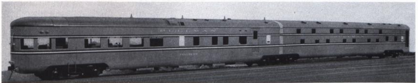
Rame articulée: voiture de luxe et voiture-lit à étage, construite par PULLMAN Co, Etats-Unis. Tare de la rame 101 tonnes. Les boîtes d'essieux sont du type représenté par la figure 22.
