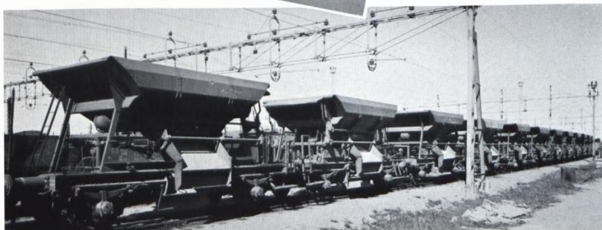
CHEMINS DE FER DE L'ETAT SUEDOIS. Wagon à macadam. Tare 11,85 tonnes, charge utile 20 tonnes.
