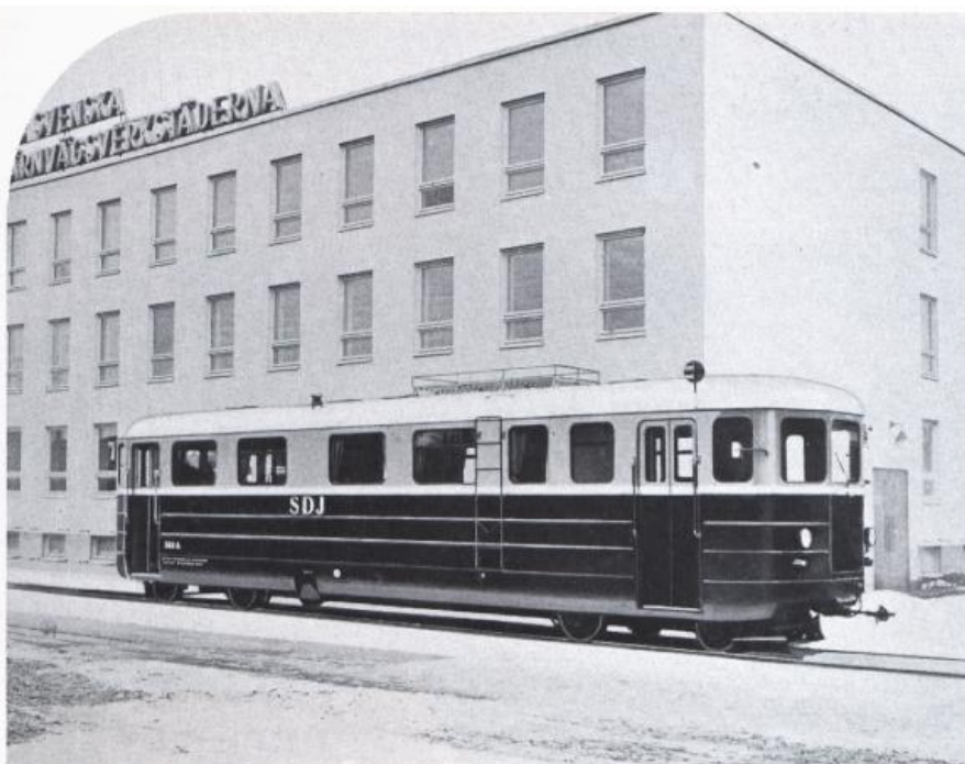
CHEMINS DE FER DE L'ETAT SUEDOIS. Auto-rail construit par ASJ, Suède, équipé de roues folles munies de roulements à rouleaux. Puissance 140 ch, vitesse maximum 80 km/h. 48 places assises et 45 places debout. Tare 14 tonnes, charge utile 8 tonnes.
