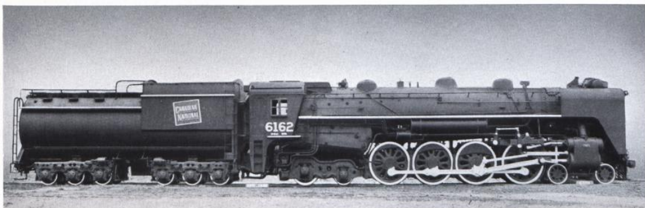
CHEMINS DE FER CANADIAN NATIONAL, CANADA. Locomotive construite par Montreal Locomotive Works, Ltd, Canada. Des boîtes à rouleaux sont utilisées sur les essieux du bogie avant, du bogie arrière et du tender. Poids en service de la locomotive 180 tonnes, du tender 130 tonnes.
