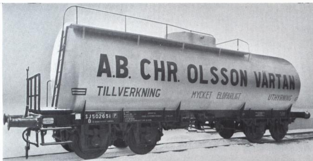
Wagon-citerne de 60 m 3 , entièrement soudé, construit par AB Chr. Olsson, Stockholm. Tare 19,2 tonnes, charge utile 42 tonnes. La figure de la page 50 montre le type des boîtes d'essieux utilisées.
