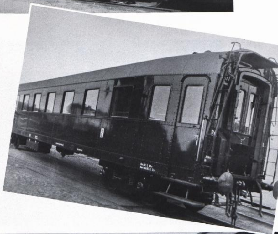
CHEMINS DE FER DE L'ÉTAT ROUMAIN. Voiture à voyageurs. Tare 38 tonnes. La figure de la page 48 montre le type des boîtes d'essieux utilisées.
