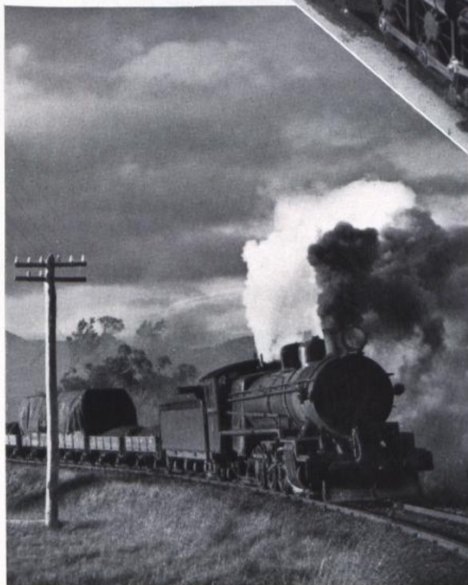
CHEMINS DE FER DE L'ETAT, TASMANIE, AUSTRALIE. La locomotive est équipée de boîtes à rouleaux sur les essieux du bogie avant, du bogie arrière et du tender.
