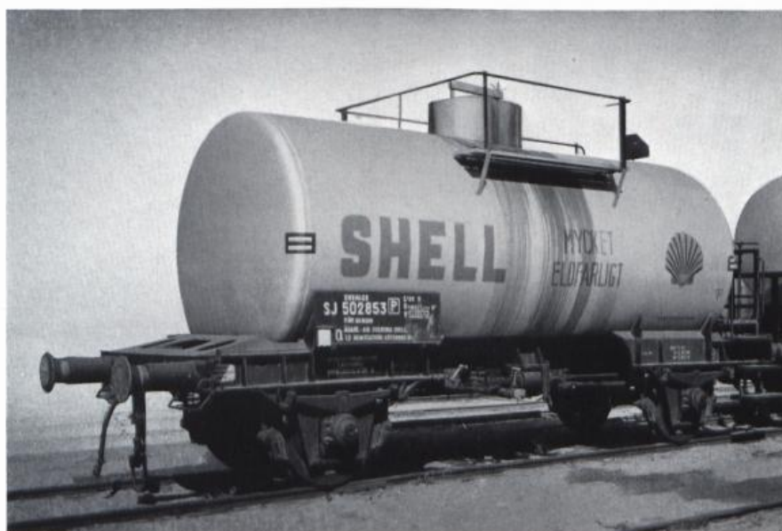
AB SVÈNSKA SHELL, SUEDE. Wagon-citerne de 27,8 m 3 , entièrement soudé, construit par AB Chr. Olsson, Stockholm. Tare 11,2 tonnes charge utile 20 tonnes. La figure de la page 50 montre le type des boîtes d'essieux utilisées.
