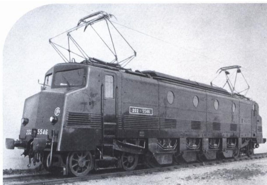
SOCIÉTÉ NATIONALE DES CHEMINS DE FER FRANÇAIS. Locomotive électrique construite par CEM et C ie de Fives-Lille. Des boîtes à rouleaux, du type représenté par la figure 72, sont utilisées sur les essieux des bogies porteurs. Puissance 3520 ch, vitesse maximum 150 km/h. Poids en ordre de marche 132 tonnes.
