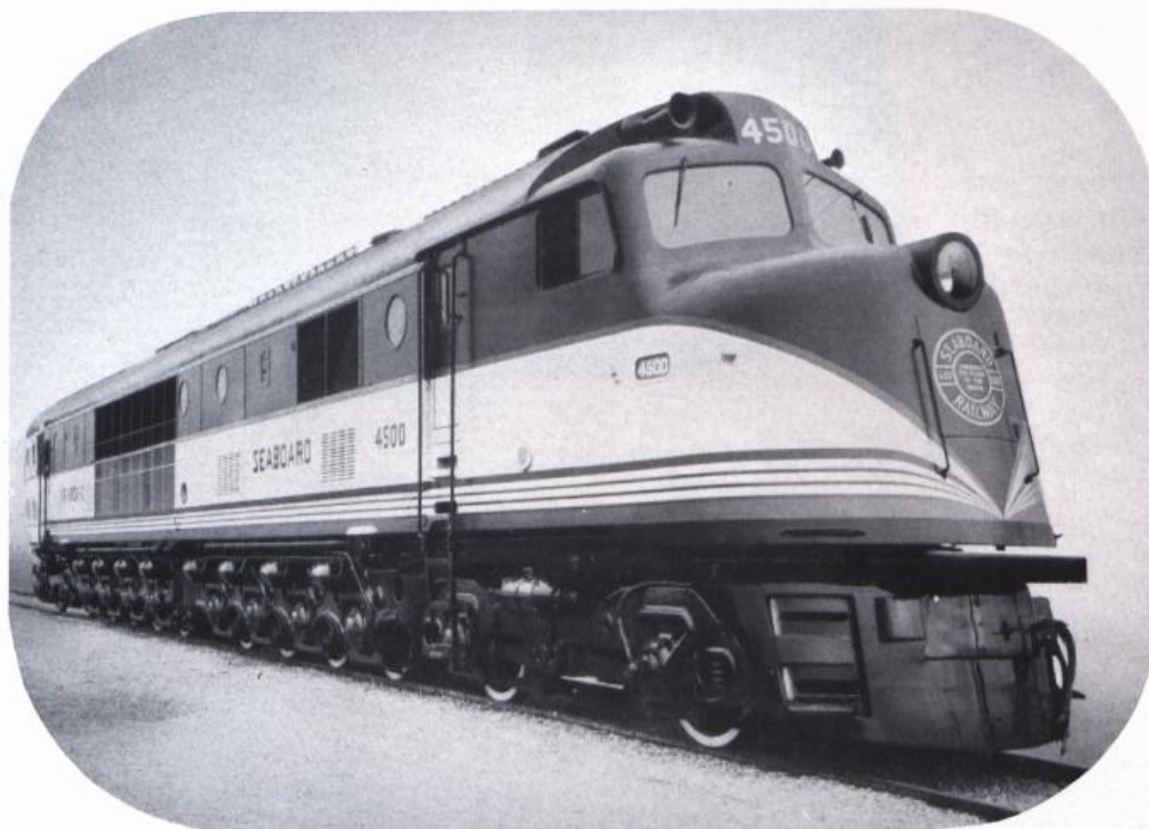
CHEMINS DE FER SEABORD, ETATS-UNIS. Locomo- tive diesel-électrique, construite par Baldwin, Etats- Unis, entièrement équipée de boîtes à rouleaux. Pui- sance 3000 ch, vitesse 188 km/h. Poids en ordre de marche 265 tonnes.
