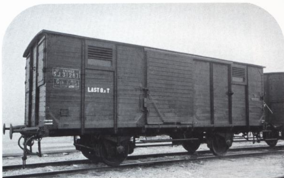
CHEMINS DE FER DE L'ETAT SUEDOIS. Wagon à marchandises. Poids maximum sur rails: 14 tonnes par essieu.
