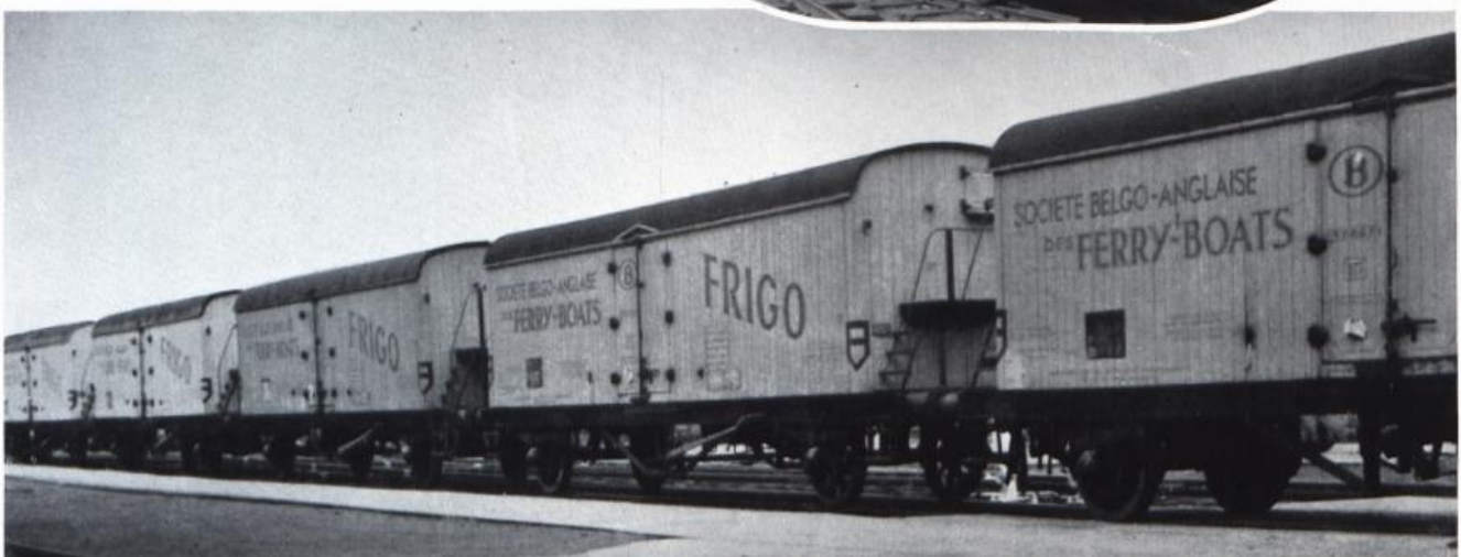
SOCIETE NATIONALE DES CHEMINS DE FER BELGES. Wagons frigorifiques construits par l'Atelier Central de Cuesme et destinés au trafic par ferry-boat entre la Belgique et l'Angleterre. La figure de la page 50 montre le type des boîtes d'essieux utilisées.
