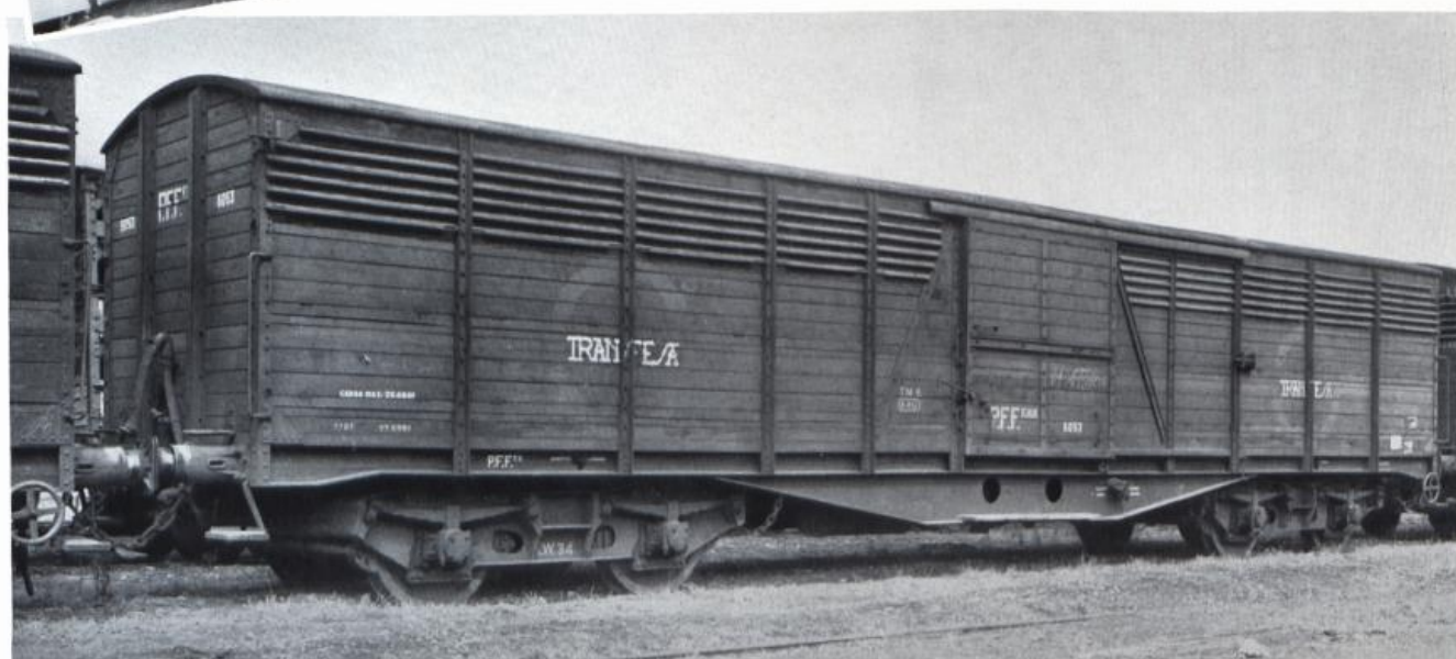
SOCIETE TRANSFESA, ESPAGNE. Wagons à bestiaux. Tare 22,6 tonnes, charge utile 25 tonnes. Boîtes d'essieux suivant la figure de la page 48.
