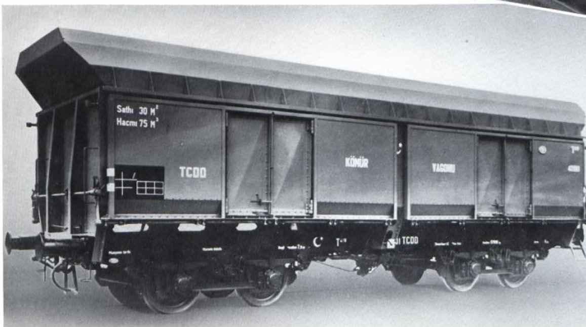
CHEMINS DE FER DE L'ETAT TURC. Wagon à charbon de 75 m 3 .
