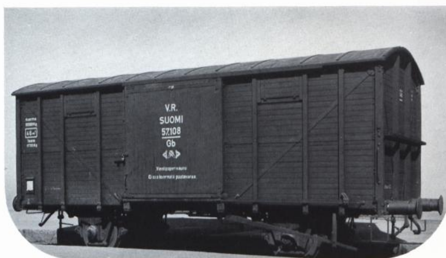
CHEMINS DE FER DE L'ETAT FINLANDAIS. Wagon construit par Kockum, Malmö, Suède. — Tare 9,7 tonnes, charge utile 16,5 tonnes. La figure de la page 50 montre le type des boîtes d'essieux utilisées.
