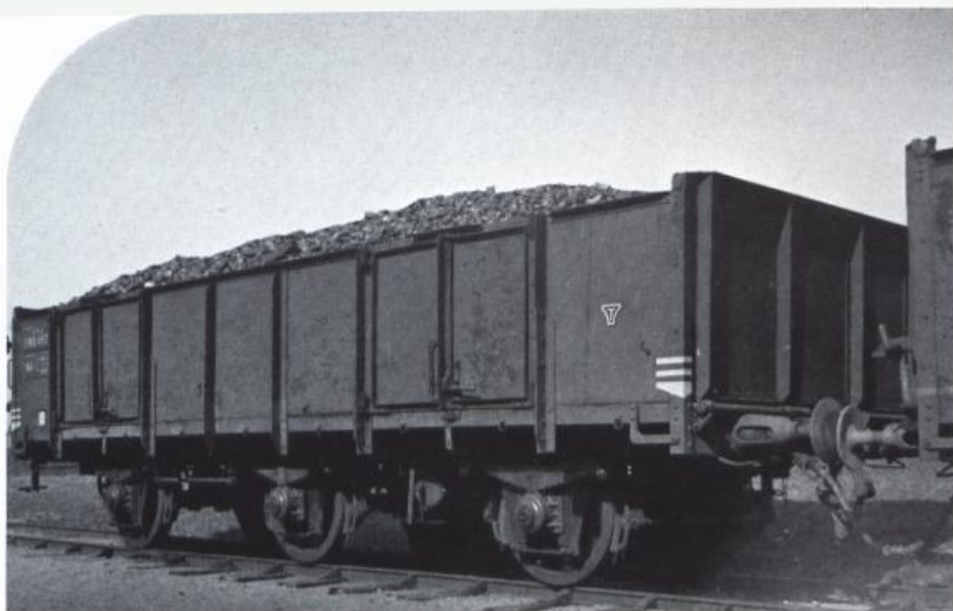
CHEMINS DE FER DE L'ETAT SUEDOIS. Wagon à minéral construit par ASJ, Falun Suède. Charge utile 36 tonnes. La figure de la page 50 montre le type des boîtes d'essieux utilisées.
