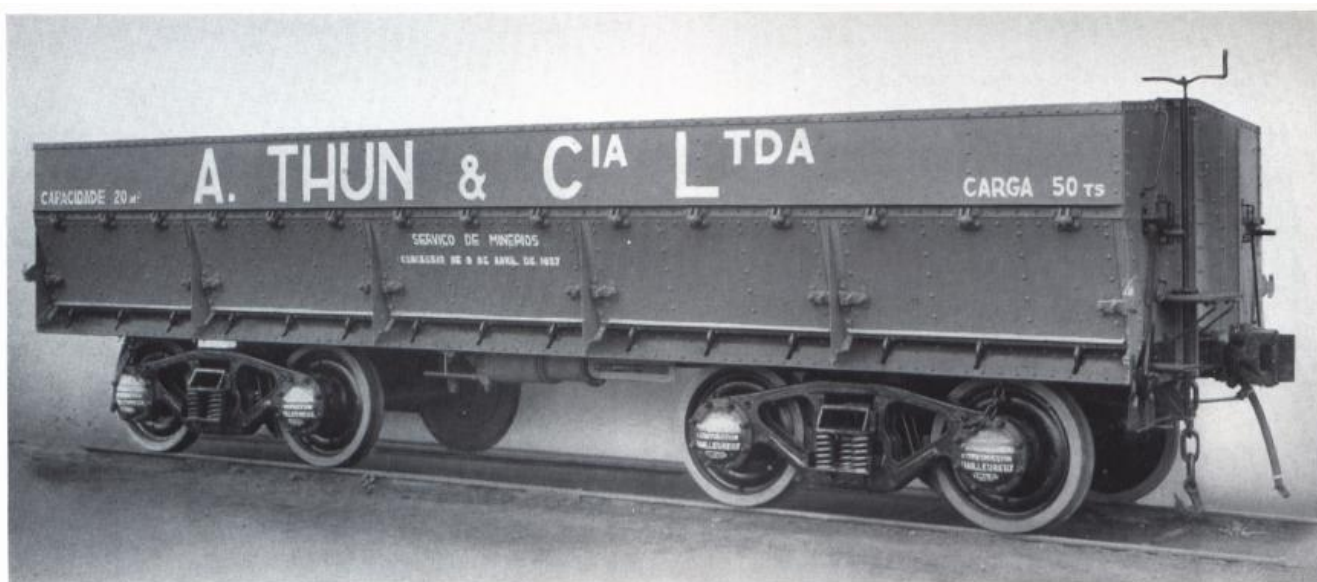
CHEMINS DE FER CENTRAUX DU BRESIL. Wagon à minerai de 20 m 3 construit par Les Ateliers de Constructions Famillereux, Belgique. Tare 18 tonnes, charge utile 50 tonnes. Bogie dit "intégral" avec roulements à rouleaux SKF, fig. 32 et 33.
