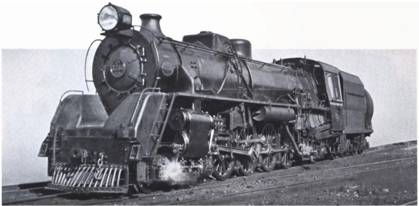
CHEMINS DE FER DE L'ETAT, NOUVELLE-ZELANDE. Locomotive construite par The North British Locomotive Co, Ltd, Angleterre. Des boîtes à rouleaux sont utilisées sur tous les essieux. Les têtes des bielles motrices sont également munies de roulements à rouleaux. Poids en service de la locomotive 68,5 tonnes, du tender, 40 tonnes.
