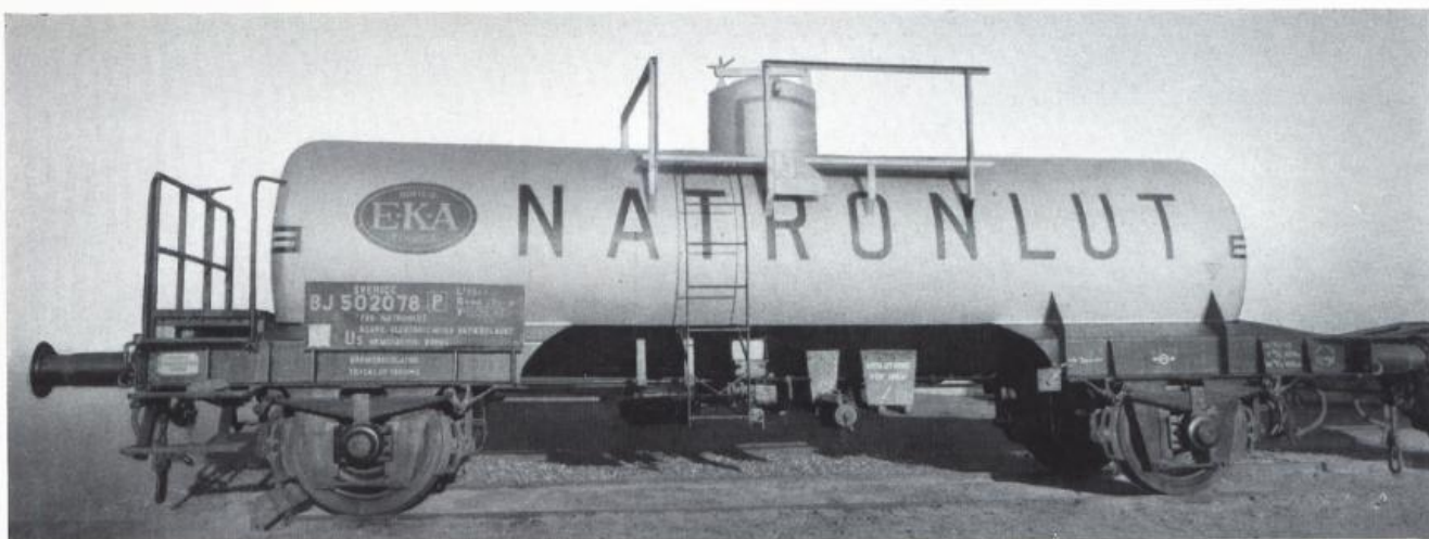
ELEKTROKEMISKA AB, BOHUS, SUEDE. Wagon-citerne entièrement soudé, construit par AB Christian Olsson, Stockholm. Tare 10,8 tonnes, charge utile 20,5 tonnes. Boîtes d'essieux suivant la figure de la page 50.
