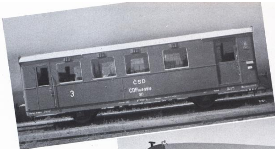
CHEMINS DE FER DE L'ETAT TCHECOSLOVAQUE. Voiture à voyageurs. Poids maximum sur rails: 10 tonnes par essieu. Les boîtes d'essieux sont du type représenté par la figure de la page 48.
