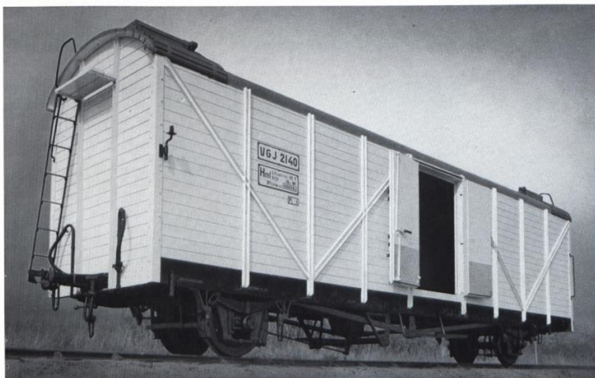
CHEMINS DE FER VGJ, SUEDE. Wagon frigorifique. Voie de 0,891 m. Tare 11 tonnes, charge utile 10 tonnes. Boîtes d'essieux suivant la figure de la page 50.
