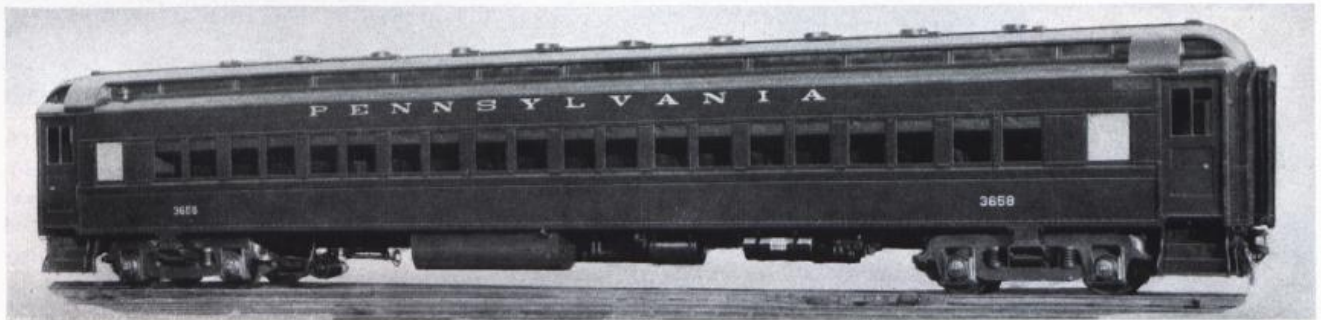
CHEMINS DE FER PENNSYLVANIA, ETATS-UNIS, Voiture à voyageurs. Poids maximum sur rails : 16 tonnes par essieu. Les boîtes d'essieux sont du type représenté par la figure 22.
