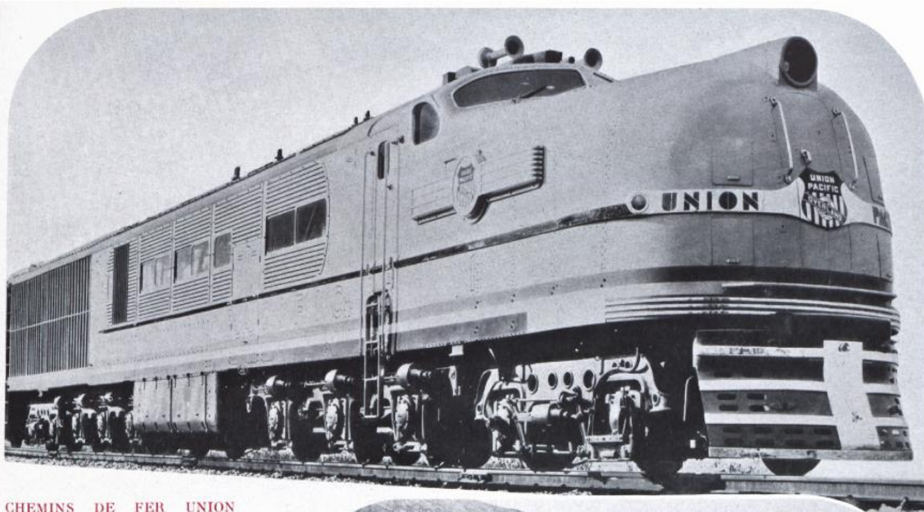
CHEMINS DE FER UNION PACIFIC, ETATS-UNIS. Locomotive électrique avec turbine à vapeur, entièrement équipée de boîtes à rouleaux.
