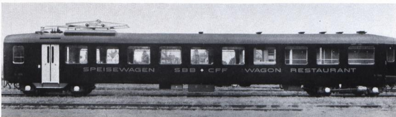
CHEMINS DE FER FEDERAUX, SUISSE. Wagon-restaurant de construction légère fabriqué par SWS, Suisse. Poids maximum sur rails: 8,4 tonnes par essieu. La figure 34 montre le type des boîtes d'essieux utilisées.
