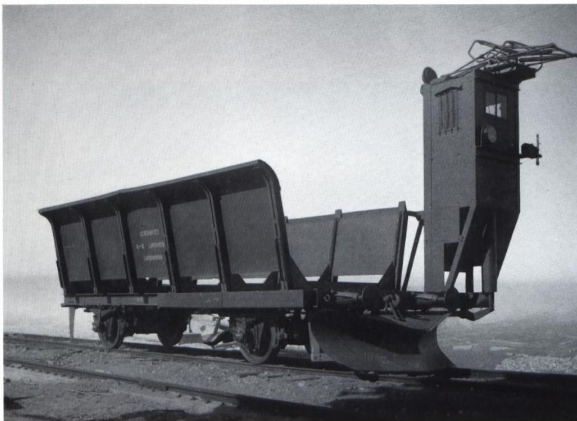
FABRIQUE DE SULFATE D'ÖSTRAND, SUEDE. Wagon automoteur pour le transport du bois, construit par AB Landsverk, Suède.
