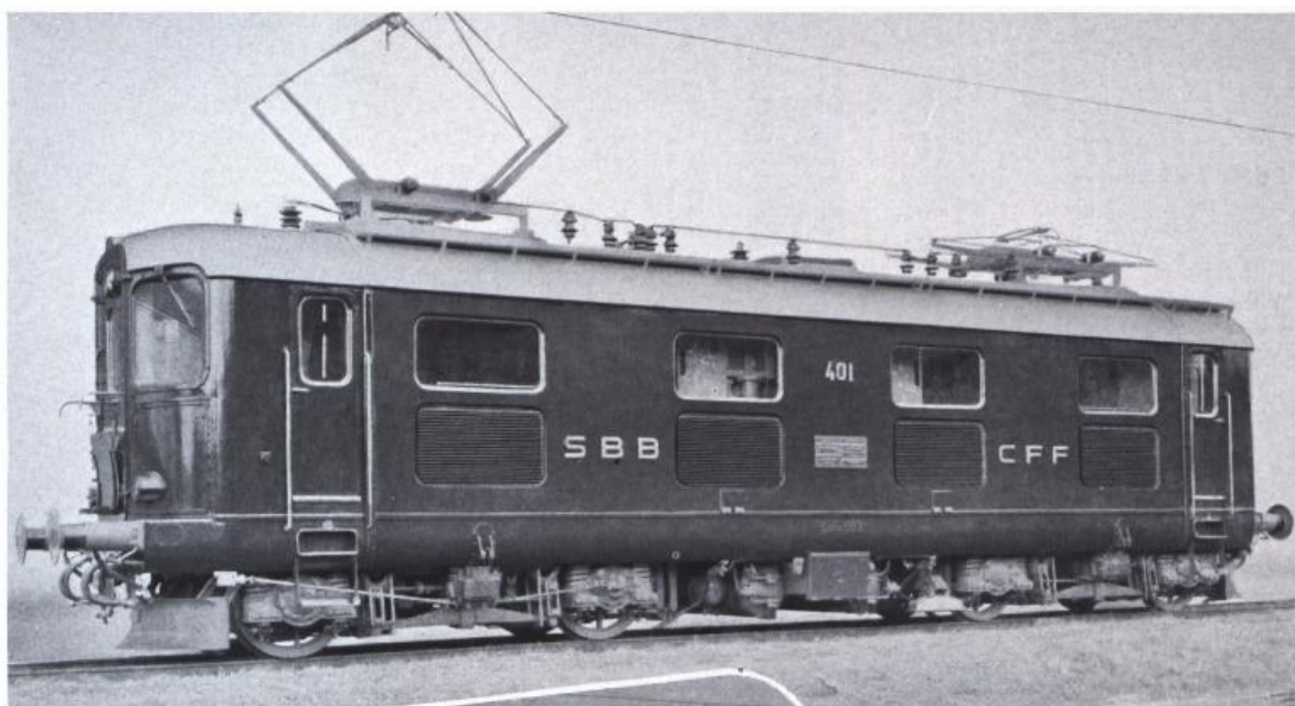
CHEMINS DE FER FEDERAUX, SUISSE. Locomotive électrique construite par SLM et BBC, Suisse, et entièrement équipée de boîtes à rouleaux du type représenté par la figure 34. Puissance 2300 ch, vitesse maximum 125 km/h. Poids en ordre de marche 56 tonnes.
