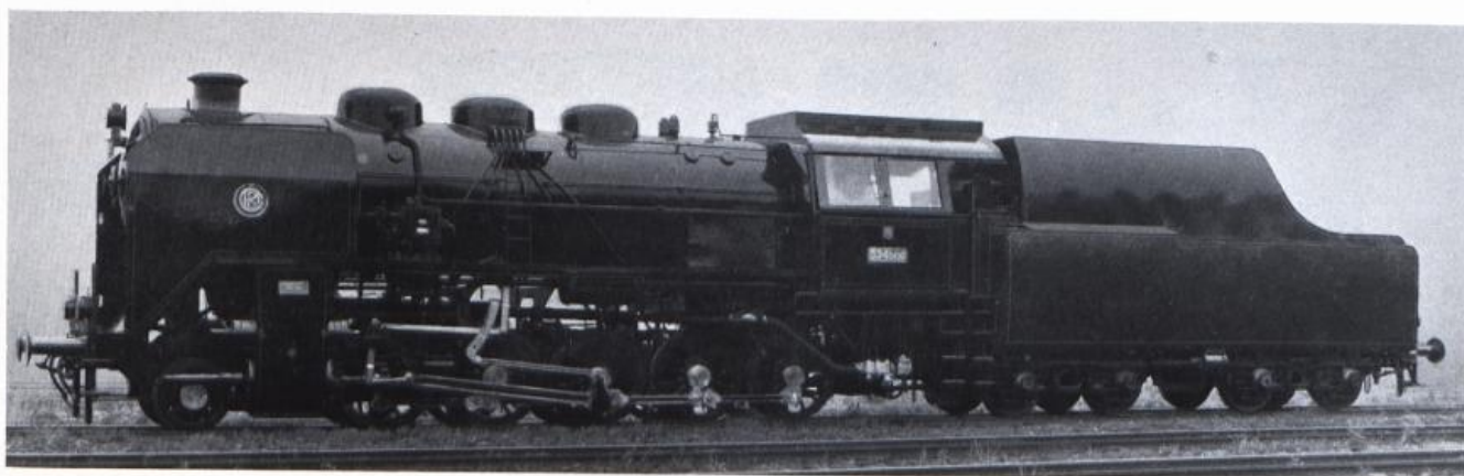
CHEMINS DE FER DE L'ETAT TCHECOSLOVAQUE. Locomotive construite par ČKD, Prague, équipée de boîtes à rouleaux sur l'essieu porteur avant et sur les essieux du tender. Poids en service de la locomotive 83 tonnes, du tender 69 tonnes.
