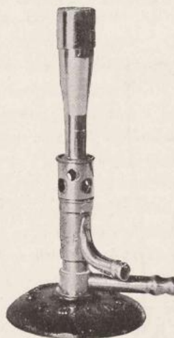
FIG. 43. Brûleur n° 3 à basse pression. (Type des n° 1 à 4).
