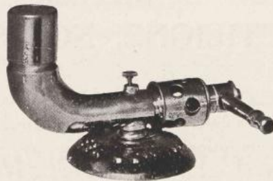
Fig. 20. — Brûleur pipe n° 3 (2 sens). Flamme horizontale.
