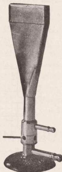
FIG. 38. Brûleur plat n° 3 à haute pression.
