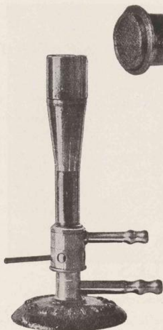
FIG. 36. Brûleur n° 3 à haute pression.
