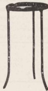
FIG. 135. — Support-trépied pour brûleurs n° 1 à 3 inclus
