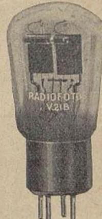
Valves Radiofotos Grammont pour tension anodique
