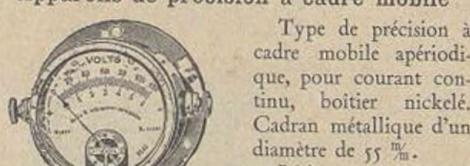
Type de précision à cadre mobile apériodique, pour courant continu, boîtier nickelé. Cadran métallique d'un diamètre de 55 mm. Résistance : 100 ohms par volt.
