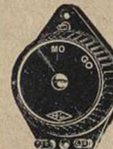
Contacteur Lelièvre pour cadre à 4 enroulements permettant en 3 positions les combinaisons suivantes :
