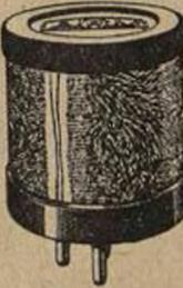
Self de choc type SX. 2.400 spires en 4 enroulements de 600 spires cloisonnés, blocage de 1000 à 5000 mètres. Livré à broches ou à pattes. Diamètre de la bobine 40 mm. Hauteur 40 mm. . . . . 30 "
