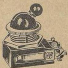
Interrupteur Bulla type 255 à fixation centrale, pièce de passage, diamètre  $15,5 \frac{m}{m}$ , unipolaire, 2 amp. 250 v., coupure brusque, grande robustesse, petit encombrement, partie visible teinte noire ou marron. Monté sur bakélite. 9 »
