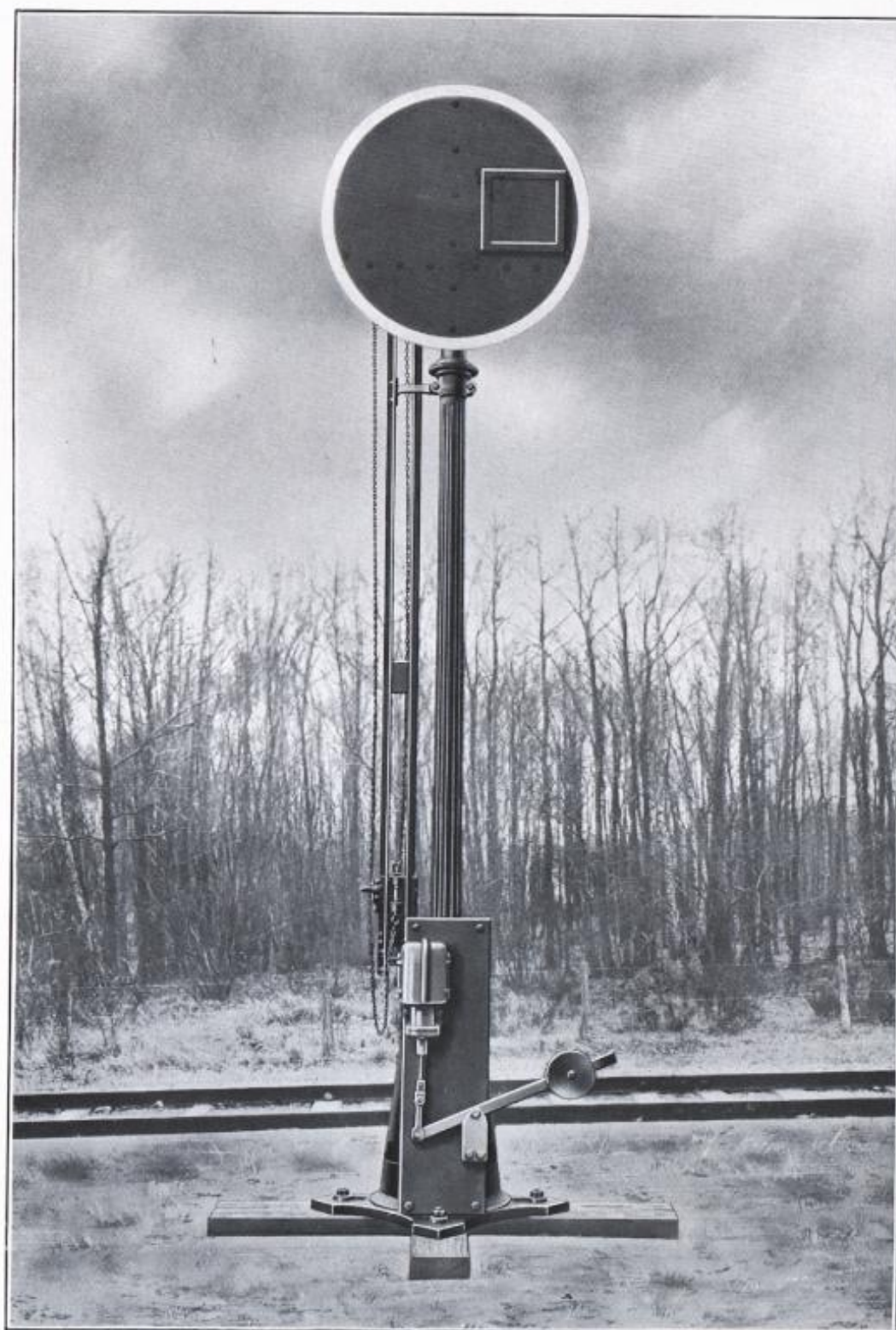
Fig. 4. — Disque commandé par un moteur électro-pneumatique.
