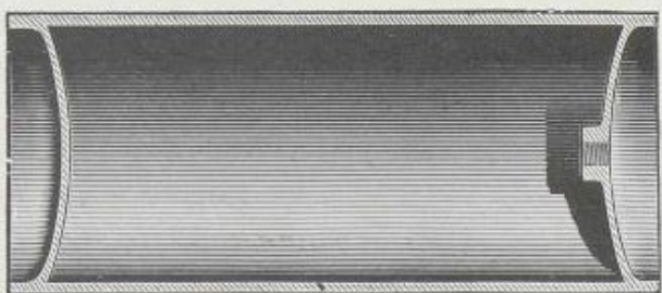
Réservoir d'air comprimé pour freins continus.
