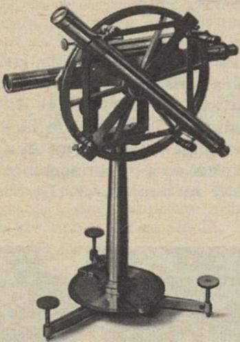
*Cercle répétiteur inventé par Lenoir d'après Borda. Cet instrument a été construit par Bellet, mécanicien qui accompagnait Delambre dans les opérations de mesure de la méridienne pour l'établissement du système métrique.*
