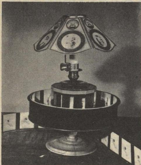
Ci-dessus : Praxinoscope d'Émile Reynaud (invention 1876). Appareil servant à donner l'illusion de mouvement animé à l'aide d'images fixes. La bande d'image est placée à l'intérieur d'un tambour dont le centre est occupé par un prisme de miroirs; la rotation du tambour reproduit les mouvements des personnages.
