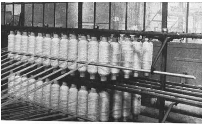
Fig. 17. — Cantre directe pour tissage de mèche VERRANNE sans torsion.
