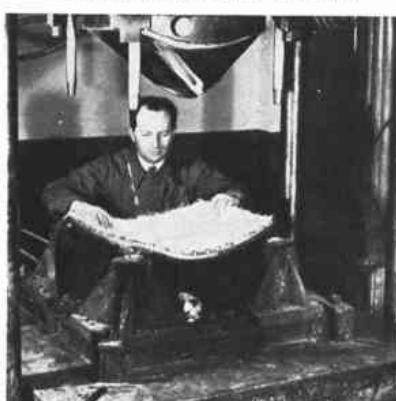
Mise en place de la préforme sur le moule.
