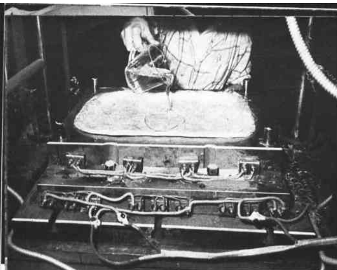
La résine est versée sur la préforme préalablement disposée dans le moule...
