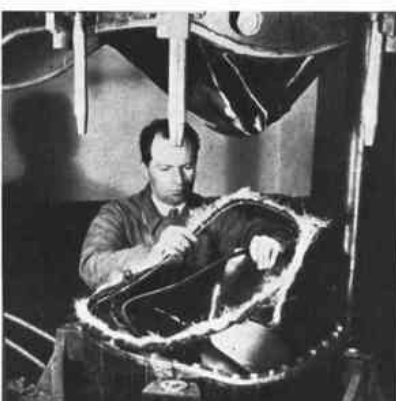
Démoulage de la pièce. (S. I. M. A. P.)
