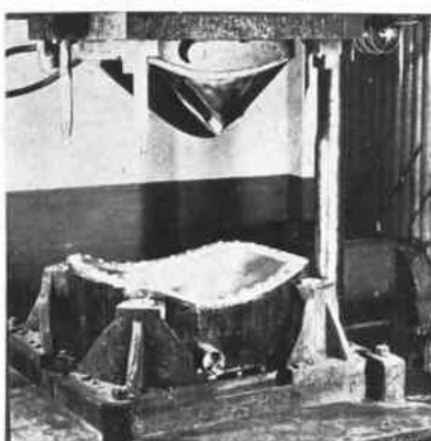
Presse basse pression avec moule et contre-moule métalliques.
