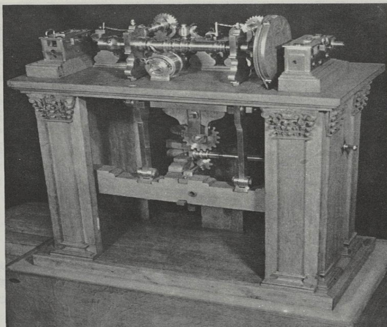
Tour à réduire les médailles construit par Andréa Nartov, mécanicien de Pierre le Grand. Le tsar a donné ce tour au célèbre mécanicien et collectionneur français Pajot d'Ons-en-Bray en 1719.
