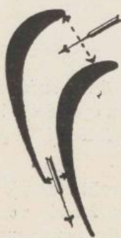
Fig. 3. — Aubage présentant une section d'écoulement allant en se rétrécissant.
