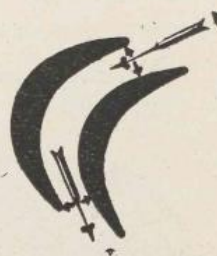
Fig. 4. — Aubage présentant une section d'écoulement constante.
