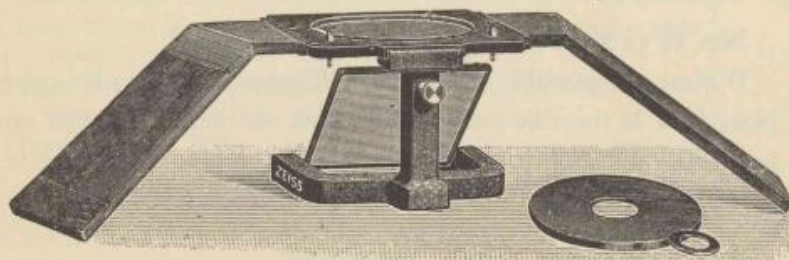
Fig. 32, \frac{1}{6} grand. nat. env. Platine à dissection pour XB et XC
