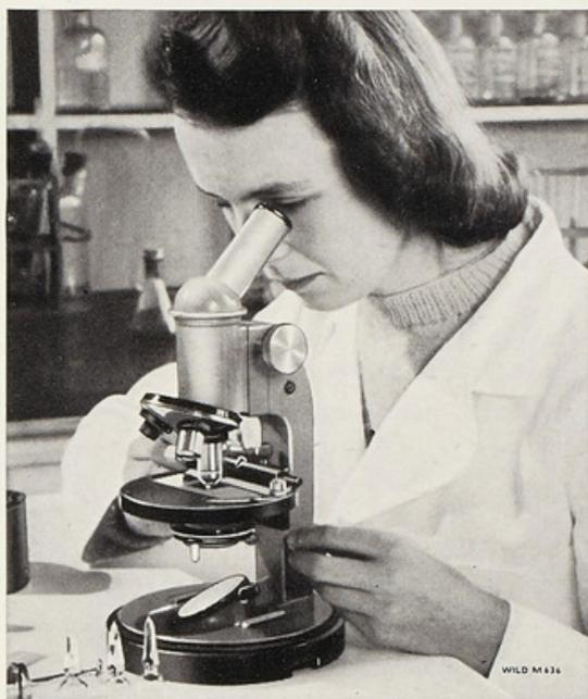
Cet instrument d'une conception nouvelle est construit selon les mêmes principes que le grand microscope WILD M 10. Il peut facilement être complété par des accessoires tels qu'éclairage épiscopique, contraste de phase, chambre microphotographique, etc., ce qui en fait un instrument complet qui n'est pas à comparer avec un microscope d'amateur. Cet instrument est recommandé pour les travaux de laboratoire, les Institutions scientifiques et le voyage.
