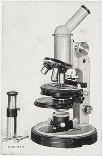
Statif M 9 ARd avec surplatine et lampe à fiche, équipé avec le dispositif WILD pour contraste de phase.
