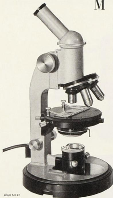
Microscope moderne, spécialement indiqué pour les laboratoires industriels et de recherches.
