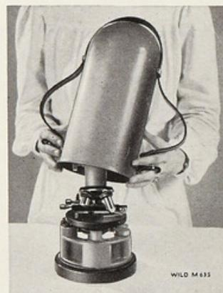
Une coiffe en acier métallique avec courroie bandoulière en cuir. Le microscope est protégé contre la poussière et l'humidité et facilement transportable. Les objectifs et oculaires se rangent à l'intérieur d'un support en forme de fer à cheval qui se place sur le socle du microscope.
