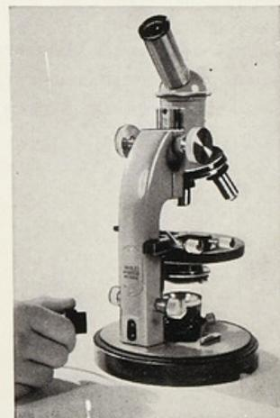
Tous les microscopes WILD possèdent des conducteurs électriques encastrés pour éclairage diascopique et épiscopique, alimentés par une fiche commune. Le support du miroir sert simultanément de contact pour la lampe à fiche WILD.
