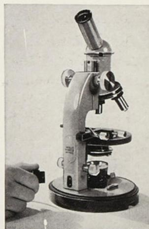
Prise commune pour éclairage diascopique et épiscopique. Le câble d'alimentation passe à l'intérieur du statif. Dans le socle sous le miroir, on a ménagé la place nécessaire à la lampe à fiche.
