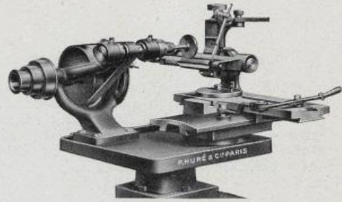
FIG. 276. Affûtage d'un taraud.
