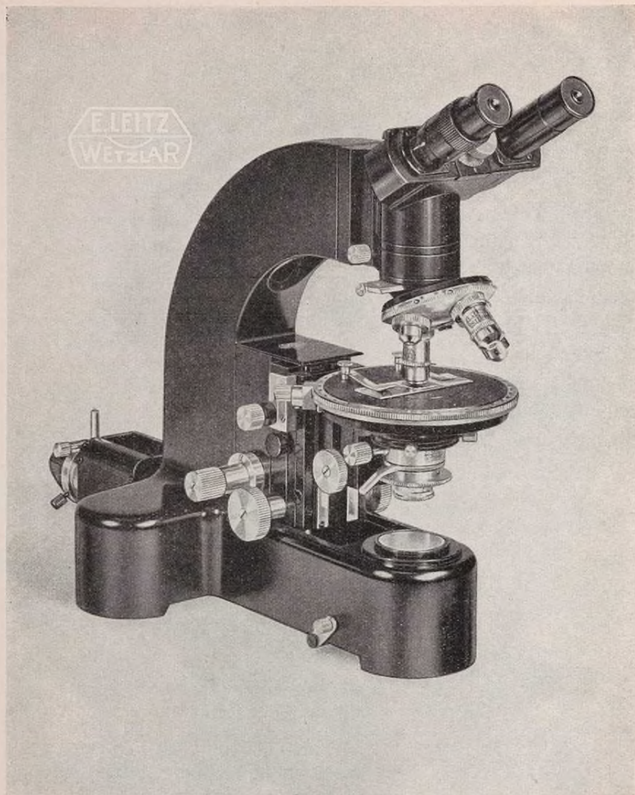
Microscope ORTHOLUX équipé pour observations biologiques en lumière polarisée ; avec platine tournante, révolver à centrage pour les objectifs.
