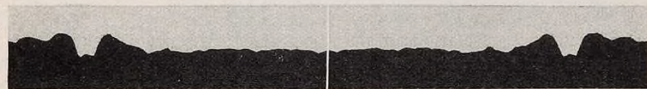
Métal léger, rectifié. Vérification des mesures par marche arrière de l'appareil. (tube 1.000×vitesse de l'échantillon 1 mm/mn).
