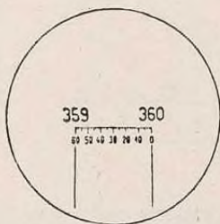
Mesure d'angle avec l'oculaire goniométrique 1 er réglage
