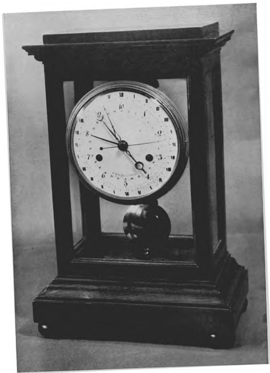
Fig. 72. — Pendule à temps décimal et sexagésimal par P.-B. Le Paute (14568).
