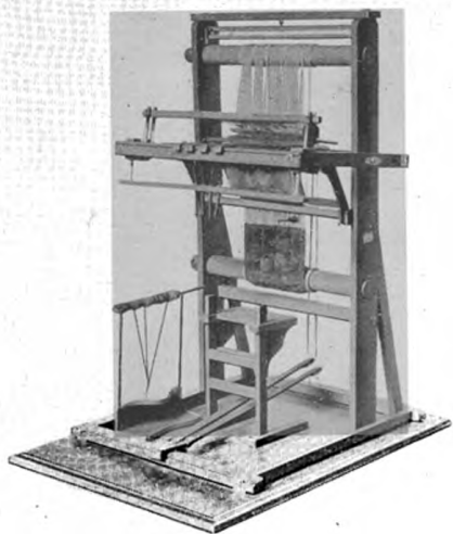
Fig. 50. — Métier à haute lisse (6.958).
