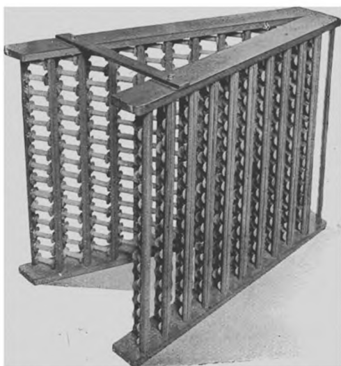
Fig. 24. — Cantre ou Porte-bobines d'ourdissoir (5.342).
