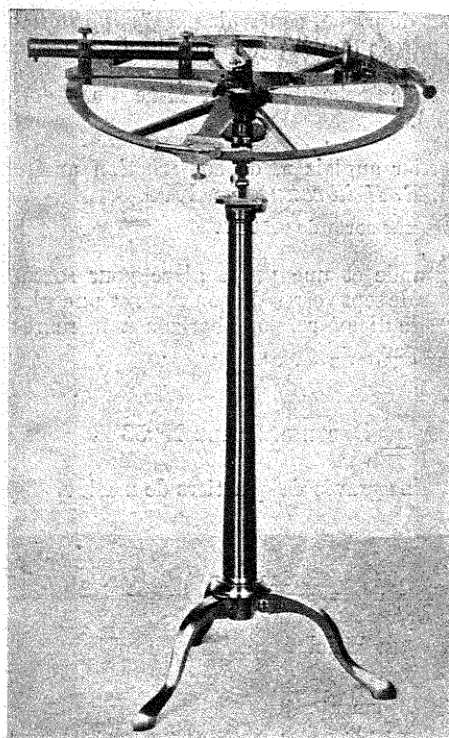
Fig 30. — Cercle à réflexion de Borda . (V. N° 1842.)
