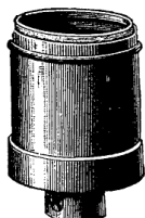
5202 Support en cuivre, modèle cylindrique, isolant intérieur en porcelaine, sans collerette en porcelaine. (Très employé pour le montage des bronzes). LE CENT. FR.: 95. »
