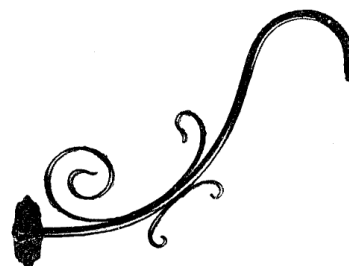
N° 12213. — Tube fer de 21 millim. de diam. Patère fonte de 17 centimètres. Saillie totale : 75 centimètres. De la base au raccord du haut : 22 centimètres. PRIX FR. : 16. »
