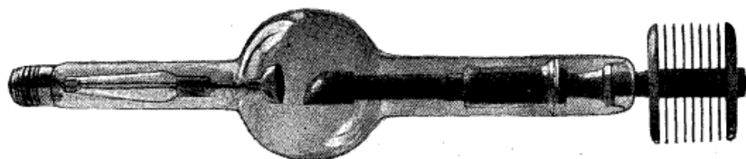
Diamètre du ballon 90 m. m. longueur 500 m. m. anticathode en cuivre avec miroir en tungstène, poids du tube 1170 grammes.
