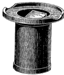
Fig. 33. — Polarizzatore (grand. naturale).
