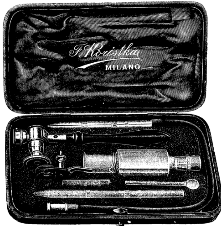
Fig. 42. — Cromocitometro Bizzozero (metà della grandezza naturale).
