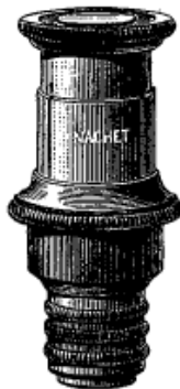
Fig. 47. Système d'objectif pour dissection.
