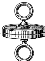
N° 311 P. Plans de Magdebourg . Deux plans de glace montés dans des armatures à crochet sans support pour montrer l'attraction moléculaire des liquides . . . . . 50 »
