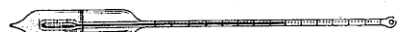
N° 714 P. Thermomètre de Despretz plongé dans l'eau privé d'air pour montrer que dans certains cas l'eau reste liquide à une température inférieure à 0 degré . . . . . 75 »
