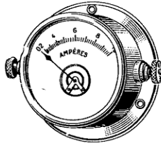
N° 2525 P. Ampèremètre thermique de tableau, diamètre 55 mm/m gradué de 0 à 1, 2, 3, 4 ou 6 ampères, pour courant continu ou alternatif. 80 »
