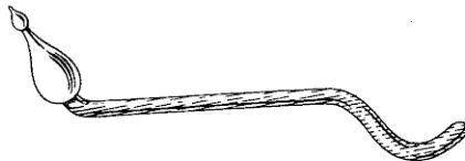
N° 663 P. Marteau d'eau de Dony , l'eau privée d'air n'entre pas en ébullition . . . . . 20 »
