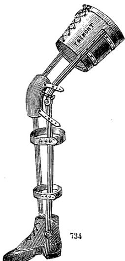
1756. Appareil semelle métallique, étrier articulé, montants latéraux nervés à rallonges et embrases, articulation à marteau et vis de pression au genou, 1/2 cuissard, cuir moulé.
