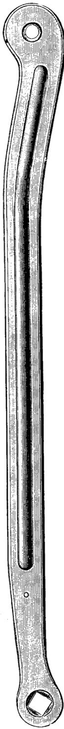
**Montant tibial interne, forgé à nervure dans la barre d'acier.**
