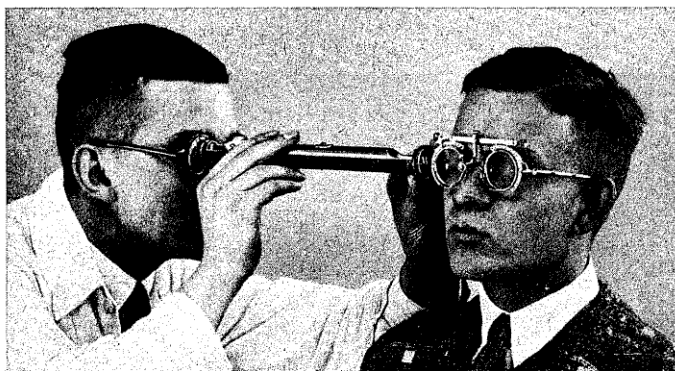
Bild 79. Das Wessely'sche Keratometer; Messen des Abstandes des Probier- glasscheitels vom Horn- hautscheitel
