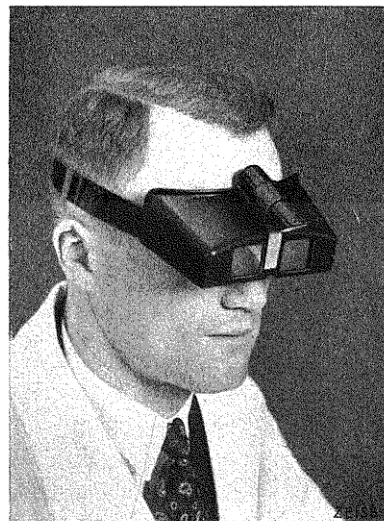
Bild 85. Die binokulare Kopflupe mit Beleuchtungseinrichtung. 23018
