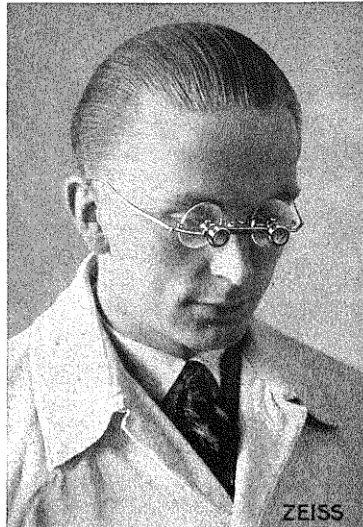
Bild 84 13382 Die Brillenlupe mit Punktgläsern für Fehlsichtige.
