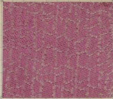
2- Soie et Viscose (réserve de la soie) - Viscose : Rose direct solide 2 BL 2%
