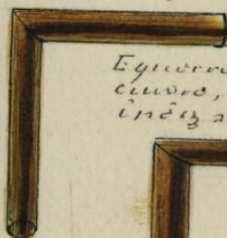
Equerre en tubes cuivre, diamètres égaux
