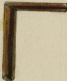
Equerre en tubes cuivre, diamètres inégaux
