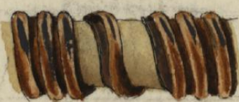
Structure du tube métallique flexible
