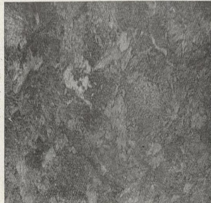
1 cm 3 trempé à l'huile \left\{ \begin{array}{l} 850^{\circ} \\ 150 \end{array} \right\}
