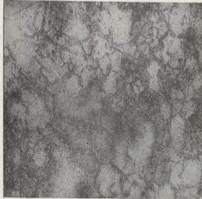
1 cm 3 trempé à l'huile \left\{ \begin{array}{l} 850^{\circ} \\ 15^{\circ} \end{array} \right.
