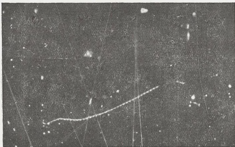
FIG. 8. — Poussières ; rayures de polissage du moule décalquées sur la surface du verre organique ; abrasion produite par un outil. Eclairage par réflexion, fond noir ( G = 250 diamètres).
