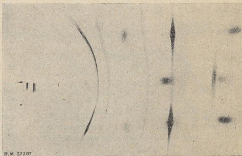
Fig. 5. — Diagramme de diffusion d'un monocristal \text{AuCu}_3 revenu 2 h à 175^\circ (Rayonnement \text{CuK}\alpha — Chambre cylindrique de diamètre 76 mm). Axe [100] vertical. Cristal oscillant autour de [100] de façon que la face (010) fasse, avec les rayons incidents, un angle variant de 18^\circ à 34^\circ . Les courbes continues sont dues à la diffraction de particules microcristallisées accompagnant le monocristal étudié.
