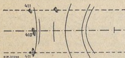
Fig. 6. — Reproduction schématique d'un diagramme du cristal \text{AuCu}_3 revenu 2 h à 175^\circ orienté de façon à faire apparaître le nœud de surstructure 411.
