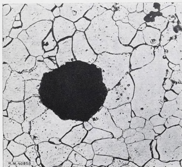
Fig. 4. — Fonte à matrice ferritique. \times 500 .
