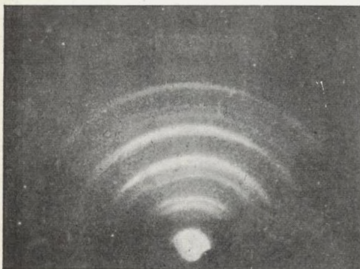
Fig. 34. — Projection cathodique de platine. a) Sans orientation: b) Avec orientation des microcristaux.
