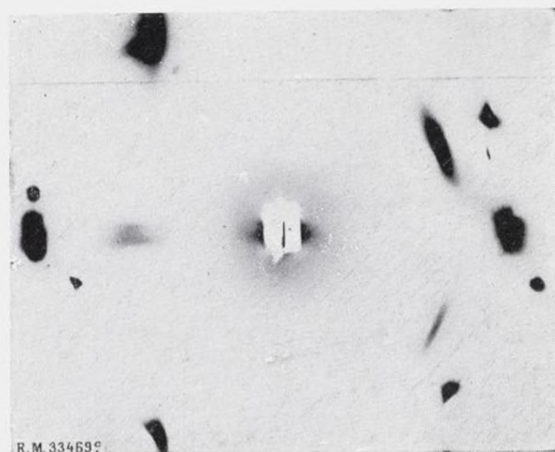
Fig. 24. — Les trois clichés ont été pris dans des conditions identiques sur un même cristal Cu-Gl (2.3 % G') à des stades de revenu différents. Le cristal oscille autour d'un axe [110] vertical : les rayons X incidents font avec l'axe [001] un angle variant de 0 à 30°. La pellicule est enroulée sur un cylindre de 38 mm de rayon, l'échantillon étant sur l'axe. Radiation \text{CuK}\alpha . Régime du tube : 40 kV, 4 mA. Temps de pose : 2 heures. Clichés en vraie grandeur. a) Alliage après un revenu de 20 h. à 195°. — b) Alliage après un revenu de 14 heures à 205°. — c) Alliage après un revenu de 14 heures à 420°.
