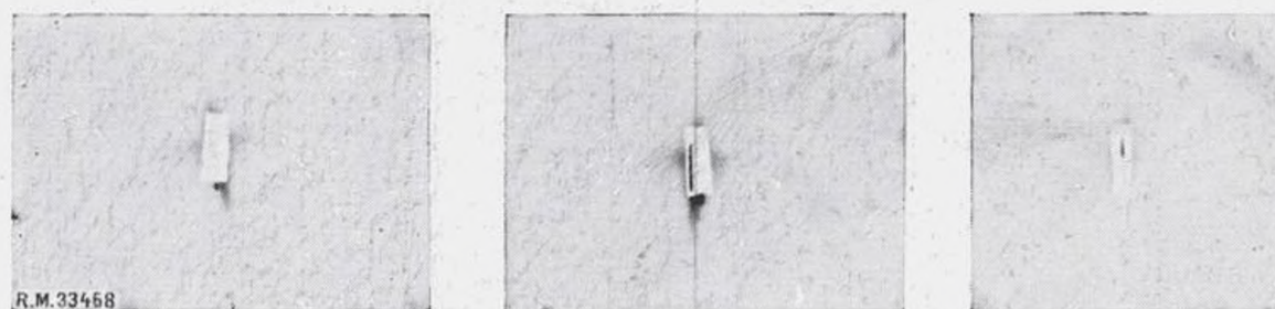
Fig. 23. — Diagrammes de diffusion centrale donnés par un monocristal de Cu-Gl à divers stades de revenu. Les rayons incidents sont dirigés suivant l'axe [100]; les axes [010] et [001] sont à peu près vertical et horizontal. Rayonnement Cu K \alpha . Distance de l'échantillon au film : 40 mm. Clichés en vraie grandeur. Régime du tube : 30 kV, 10 mA. Temps de pose : 1 heure.
