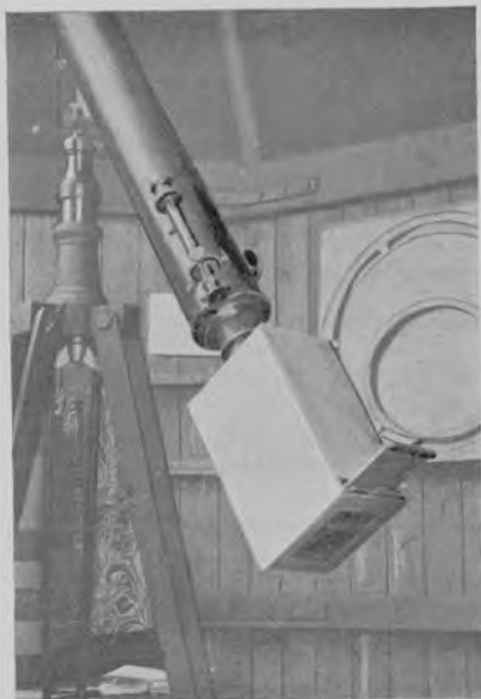
Fig. 1. — Disposition d'une chambre noire placée sur un télescope pour photographier le soleil ou la lune.
