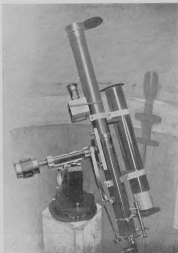
Fig. 3. — Disposition pour photographier une portion du ciel.
