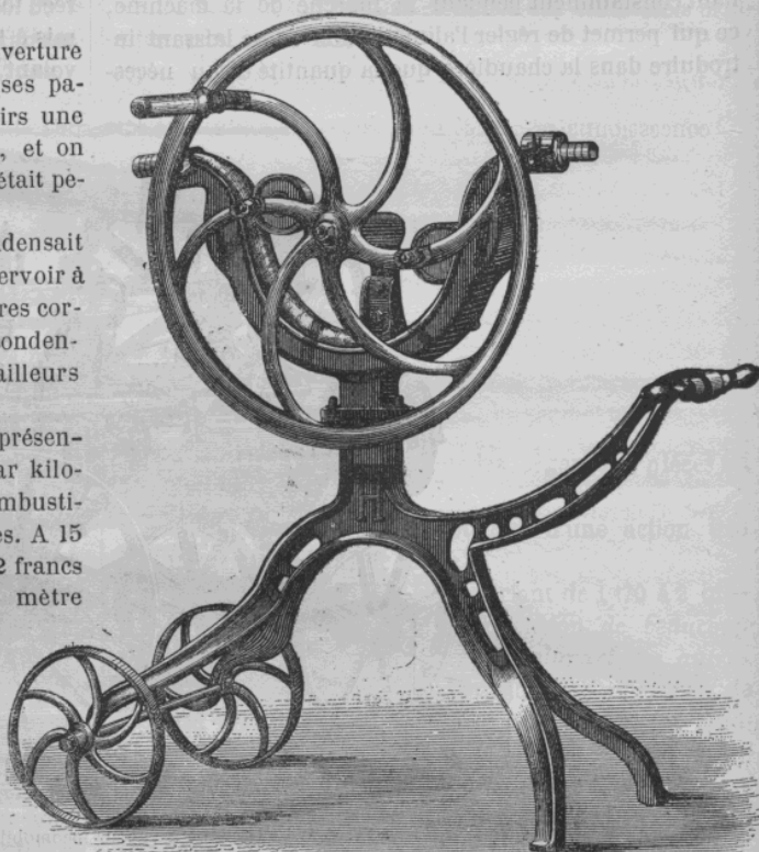
Fig. 65. — Siphon-pompe de MM. Palau et C ie .
