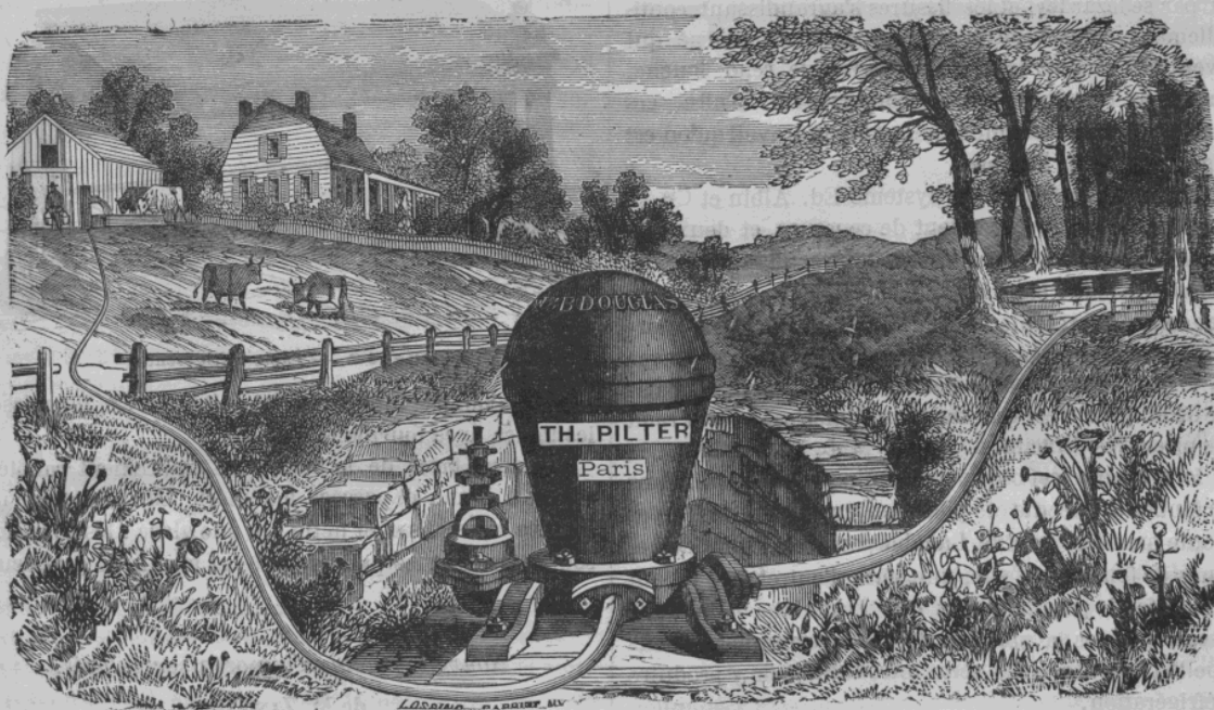
Fig. 73. — Béliet hydraulique, système Douglas.
