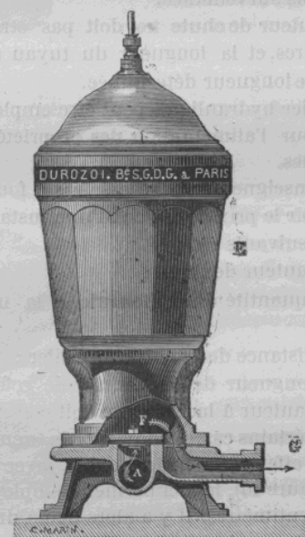
Fig. 38. — Béliet hydraulique, système Durozoi, à alimentation d'air automatique. — Fig. 39
