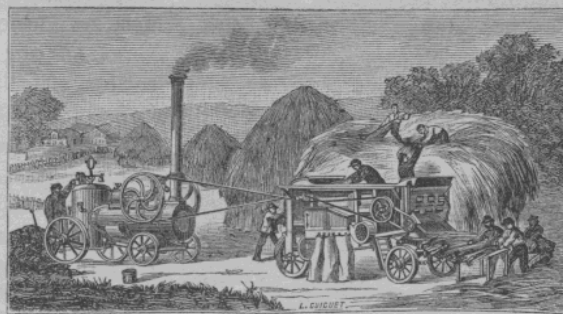
Figure 11. — Machine à battre en fonction, actionnée par une locomobile.
