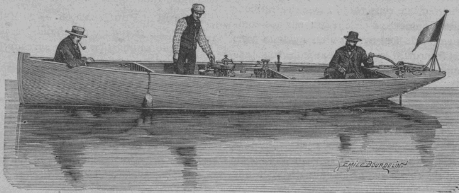
Figure 34. — Canot actionné par un moteur Lenoir à gazoline.
