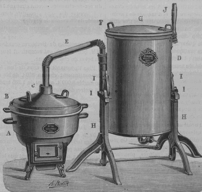
Figure 33. — Appareil pour la cuisson des légumes et racines, système Beaume.
