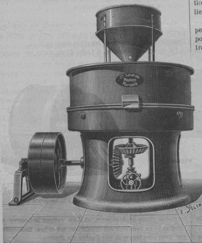
Figure 59. — Moulin à beffroi métallique et meules de Silex.
