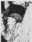
Fig. 1. Réduction graduelle du point dans une simili. Grossissement 40 diamètres.
