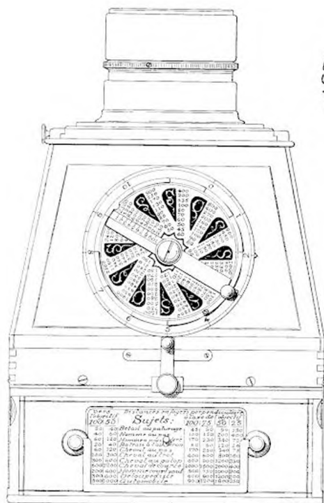
Face avec cadran des vitesses d'obturation et objectif PLANAR.
