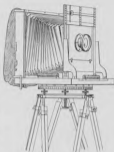
Fig. 4. Chambre noire ordinaire avec niveaux, cercle azimutal et vis de calage du capitaine Javary (1865).
