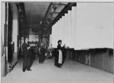
Fig. 14. — Formation des plis en U du papier émulsionné après l'étendage de l'émulsion.
